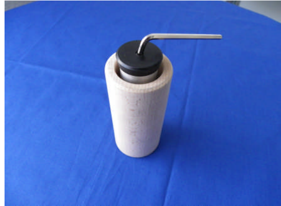
Mit dem i-6Kt. welcher sich unter dem Gleiter befindet mit einem 3.5 mm Imbusschlüssel festziehen
